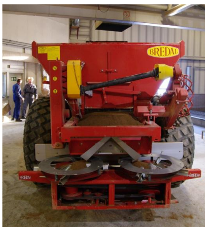
Figur 5. Då spridaren Bredal K65 provades med benmjöl försågs maskinen med cirkelformade plattor ovanför spridartallrikarna. Foto: Bredal A/S.
