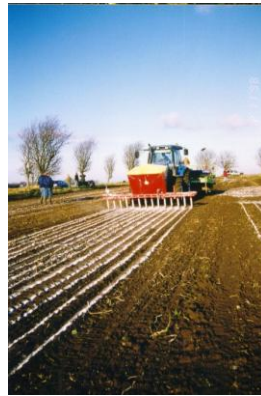
Figur 11. På den danska försöksmaskinen sker utmatningen med en kedja av samma typ som används i utfodringsanläggningar. Maskinen är frontmonterad för att kunna kombineras med andra redskap. Arbetsbredden uppgår till cirka 4 meter och behållarvolymen till cirka 1 200 liter (Møller pers. medd., 2012). Foto: Agri Contact.
