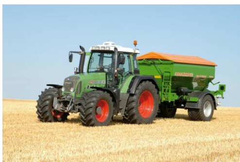
Figur 3. Spridare av centrifugaltyp för såväl kalk som konstgödsel. Utmatningen till spridarskivorna sker med bottenmatta. Vänstra bilden: Amazone modell ZG-B, effektiv arbetsbredd 1 10-52 meter. Foto: Amazone GmbH. Högra bilden: Bredal modell K45, effektiv arbetsbredd upp till 36 meter. Foto: Bredal A/S.(amazone.net & bogballe.com)
