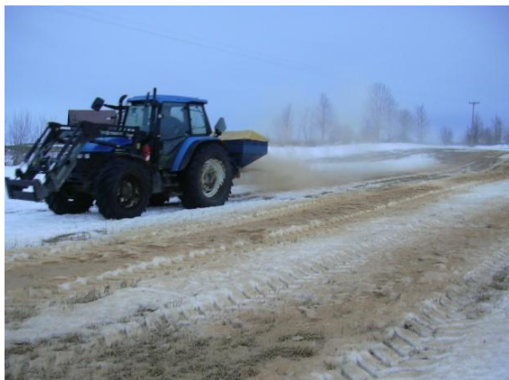
Figur 2. Spridning av benmjöl med konstgödselspridare av centrifugaltyp medför begränsade arbetsbredder. På bilden sker spridning av enstaka kördrag för att bedöma spridningsbilden. Foto: Åsa Lindqvist, Svenska Lantmännen.
