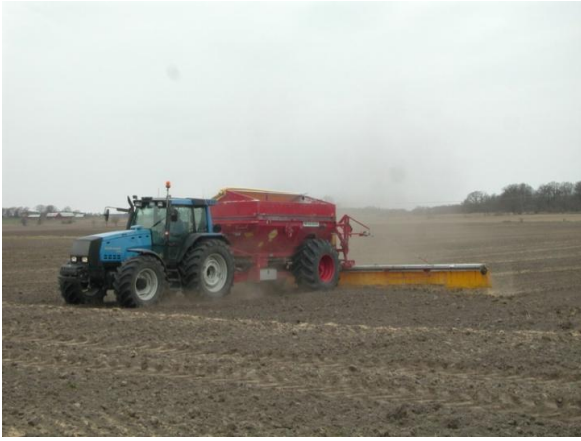
Figur 1. Spridning av benmjöl, Biofer 7-9-0, med rörspridare av fabrikat Bredal. Foto: Lars Johansson, Svenska Lantmännen
