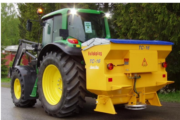
Figur 13. Tallriksspridaren Falköping TC-16 för sand, salt, singel och klorkalcium. Foto: Friggeråkers Verkstäder.
