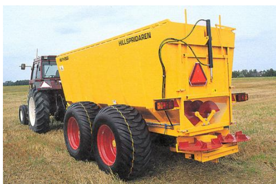
Figur 7. På Hillspridaren transporteras gödselmedlet till spridarskivorna med två skruvar i behållarbotten. Foto: Ranaverken AB.
