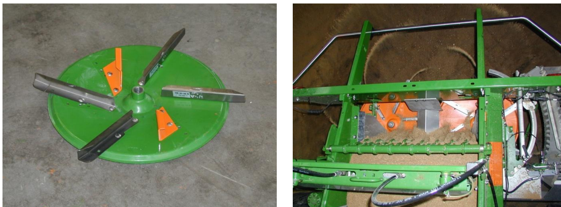
Figur 4. Vänstra bilden: Spridarskivor särskilt utformade för benmjöl. Högra bilden: Spridarskivorna (från ovan) i arbete vid spridning av benmjöl med Amazone ZG-B. Foto: Anton Knoll.
