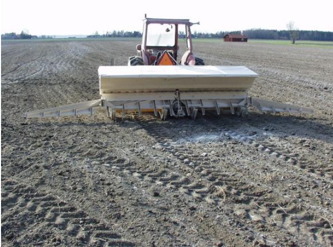
Figur 10. Spridare för växnäring, fabrikat Holm, där gödselmedlet fördelas över arbetsbredden via vibrerande plåtrännor. Maskinens arbetsbredd = rampbredden, i detta fall sex meter. Foto: Kurt Hansson.
