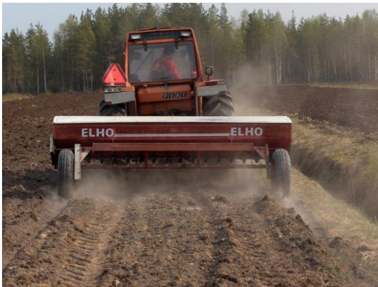
Figur 9. Spridning av benmjöl med fallspridare av fabriken Elho. Foto: Honkajoki Oy.
