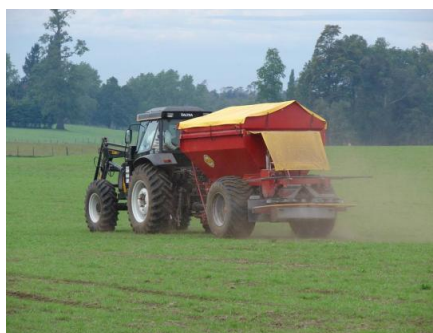
Figur 3. Spridare av centrifugaltyp för såväl kalk som konstgödsel. Utmatningen till spridarskivorna sker med bottenmatta. Vänstra bilden: Amazone modell ZG-B, effektiv arbetsbredd 1 10-52 meter. Foto: Amazone GmbH. Högra bilden: Bredal modell K45, effektiv arbetsbredd upp till 36 meter. Foto: Bredal A/S.(amazone.net & bogballe.com)
