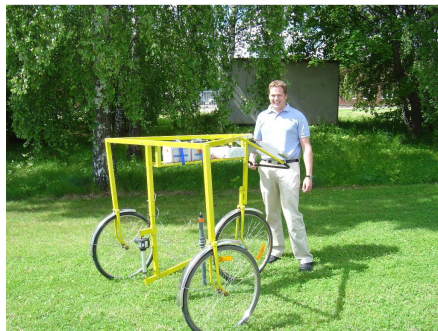
Figur 2. Den slutliga prototypen för online-mätningar av markvatten. Vagnen körs manuellt och med ett visst intervall tas ett prov som noteras i logger eller i dator.
