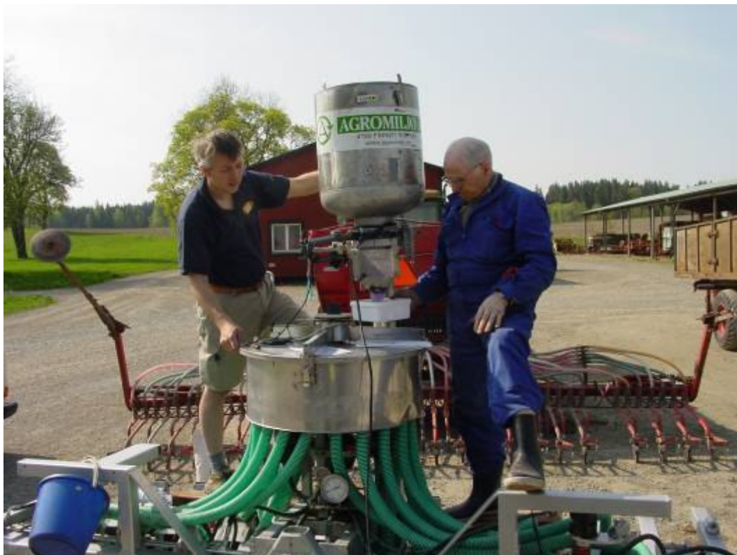
Figur 3. Utsädesbehållaren är monterad ovanför blandningsenheten
