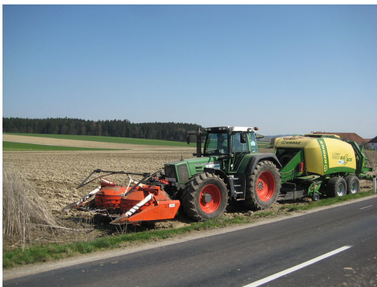
Figur 1. Ett majsbord, Kemper 3000, i fronten på en traktor och ett transportband under traktorn levererar elefantgräset till pressens pickup utan att materialet läggs på marken. Foto: Thomas Prade, SLU Alnarp
