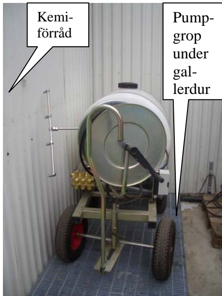
Figur 7. Spruta parkerad på gallerdurk, över en pumpgrop. Kemikalieförrådet placerat bredvid.
