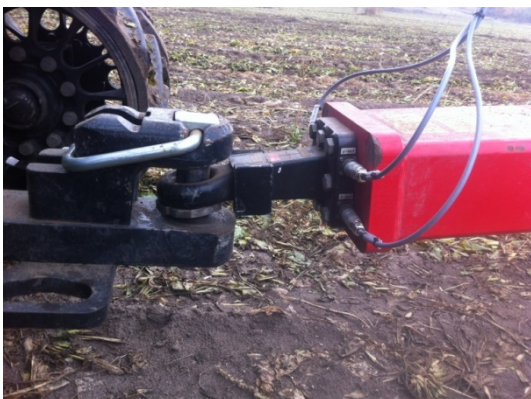
Figur 3. Det specialtillverkade draget med kraftgivare som användes vid försöken.
