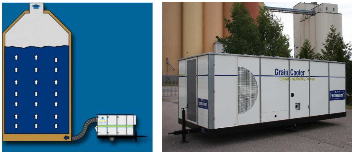
Figur 1. Vid kylagring blåses artificiellt kyld luft genom spannmålen. För att åstadkomma temperatursänkningen används aggregat uppbyggda enligt samma principer som konventionella kylskåp/värmepumpar. I den föreliggande undersökningen användes kylmaskinen TGC Tornum Grain Cooler (högra bilden). Illustration och foto: Tornum AB.
