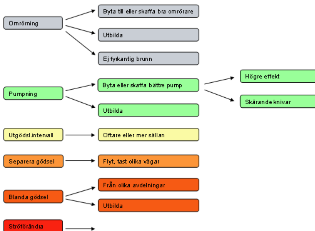
Figur 3. Förslag på åtgärder som kan förbättra gödselns pumpbarhet i pumpbrunnen.
