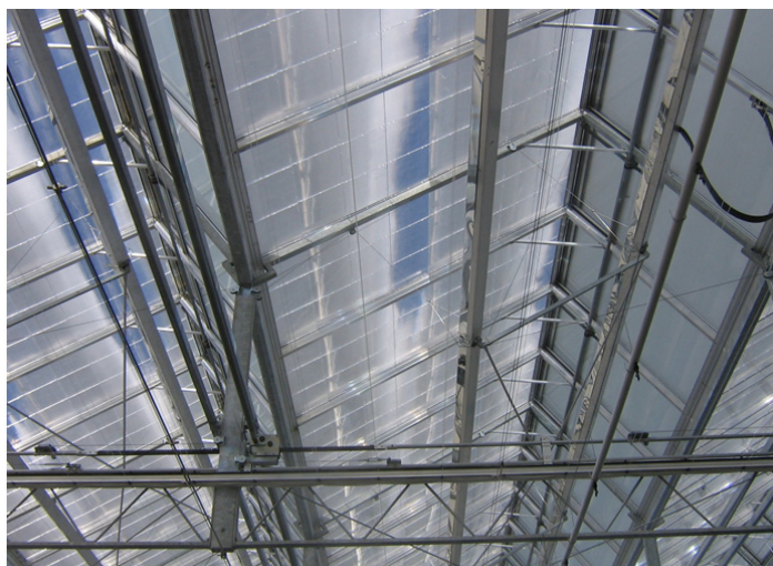
Figur 13. Interiör från ett försöksväxthus vid Wageningen WUR i Nederländerna där man gör studier av koncentrerande solcellssystem. Fresnel-linser i taket reflekterar solljuset till positionerbara längsgående profiler i nivå med takrännorna. Foto Sven Nimmermark.
