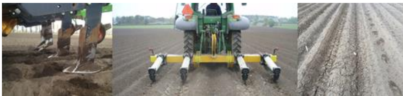
Figur 1. Djupluckrare med fyra skär samt markytan efter luckring
