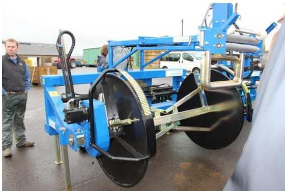
Figur 5 vänster. Maskin för att rulla på och av nät. Bild höger. Demoförsöket i Östergötland. Här ses effekt av ogräs under näten.
