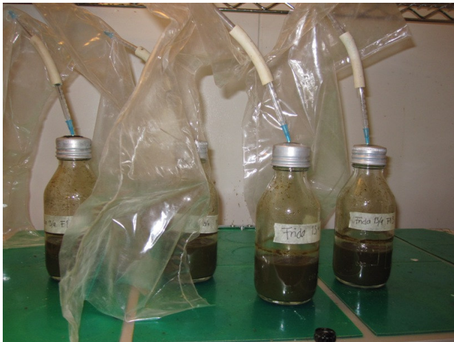
Bild 1. Modellreaktorer med 300 ml substrat och modifierad atmosfär (N 2 /CO 2 ). Reaktorerna försågs med en påse för uppsamling av bildad gas.
