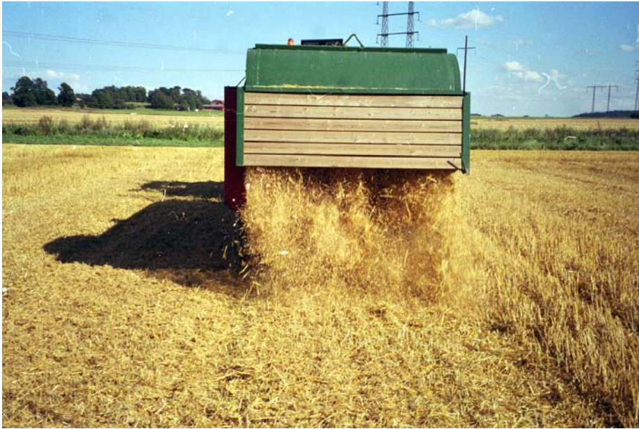
Figur 3. Halmhackelsen återförs till såbädden med en modifierad stallgödselspridare.
