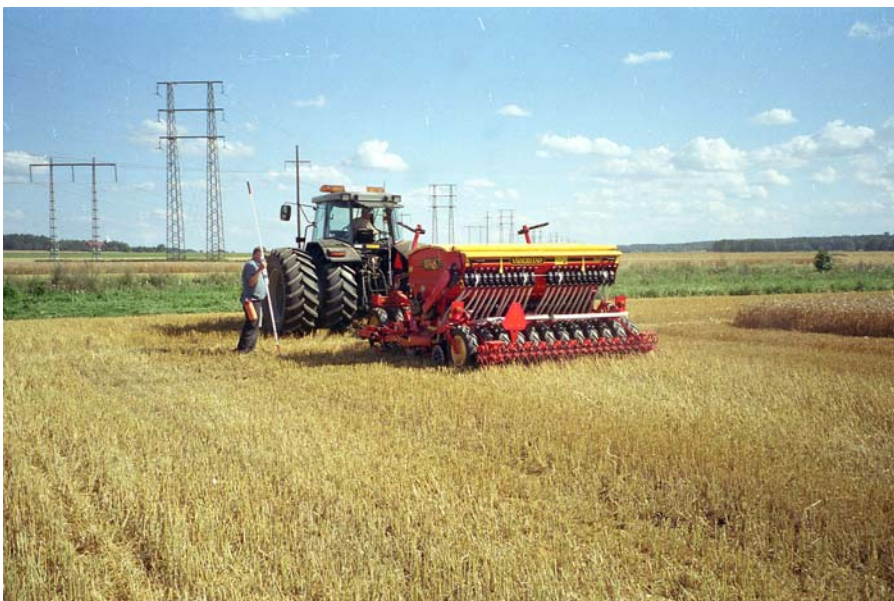
Figur 2. Sådd av oljeväxter med skivbillsförsedd såmaskin.
