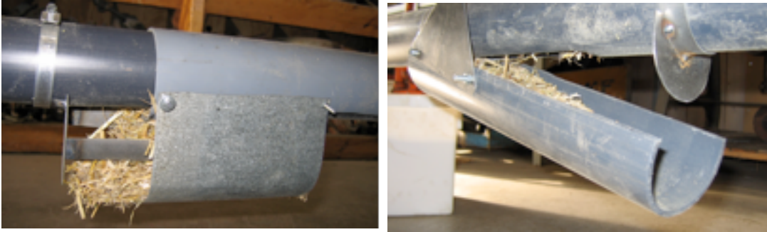
Figur 4 & 5. Nedsläpp nr 2 (t.v.) bestod av en plåtbehållare, som sköts åt sidan vid strötilfället. Nedsläpp nr 3 (t.h.) bestod av ett halvt PVC-rör som hängde en bit under nedsläppet så att det bildade en behållare. Röret fälldes vid strötilfället.
