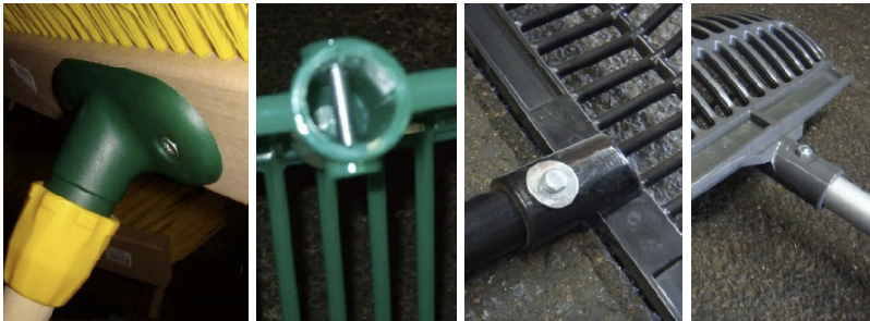
Figur 6. Exempel anslutningsanordningar mellan skaft och blad.
