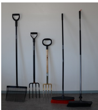
Figur 1. Redskap som användes för att simulera arbetsmomenten i laboratoriemiljö. Från vänster 1) Spångrep med rakt skaft, 2) Gödselgrep med långt rakt skaft (användes också för att simulera skyffel), 3) Gödselgrep med kort rakt skaft, 4) Sopborste med vinklat skaft och 5) Sopborste med rakt skaft (användes också för att simulera skrapa).
