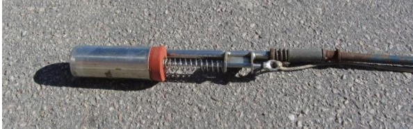
Figur 1. Cylinder för provtagning av gödsel på olika djup i gödselbehållare.
