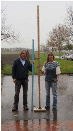
Figur 2. Utrustning för mätning av sedimentdjup i gödselbehållare eller våtmarker.
