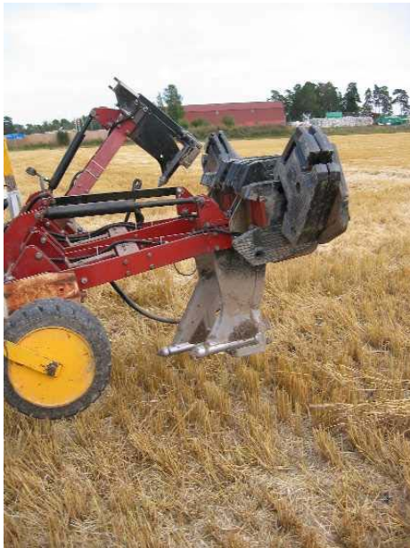
Figur 2. Den färdiga penetrometern med tre billar samt monterade traktorvikter. Den borte billen med aktiverad stenulösare. Till höger under mätning.
