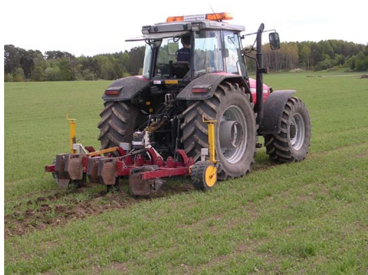
Figur 2. Den färdiga penetrometern med tre billar samt monterade traktorvikter. Den borte billen med aktiverad stenulösare. Till höger under mätning.
