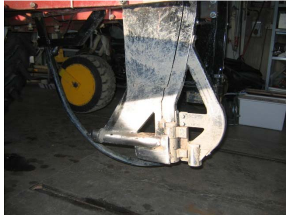
Figur 3. Prob för montering av fiberoptisk kabel och ljuskälla från sidan (v). NIR-prob monterad efter penetrometern (h).
