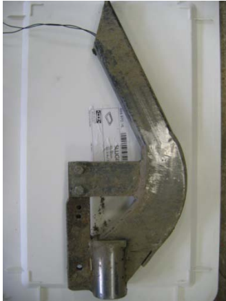
Figur 3. Prob för montering av fiberoptisk kabel och ljuskälla från sidan (v). NIR-prob monterad efter penetrometern (h).
