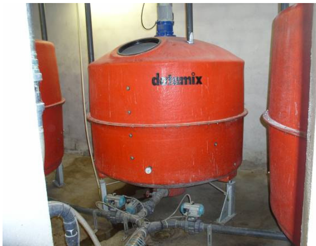
Bild 1. Fermenteringstank för spannmål som ingick som en komponent i tillväxtfodret (Gård A).
