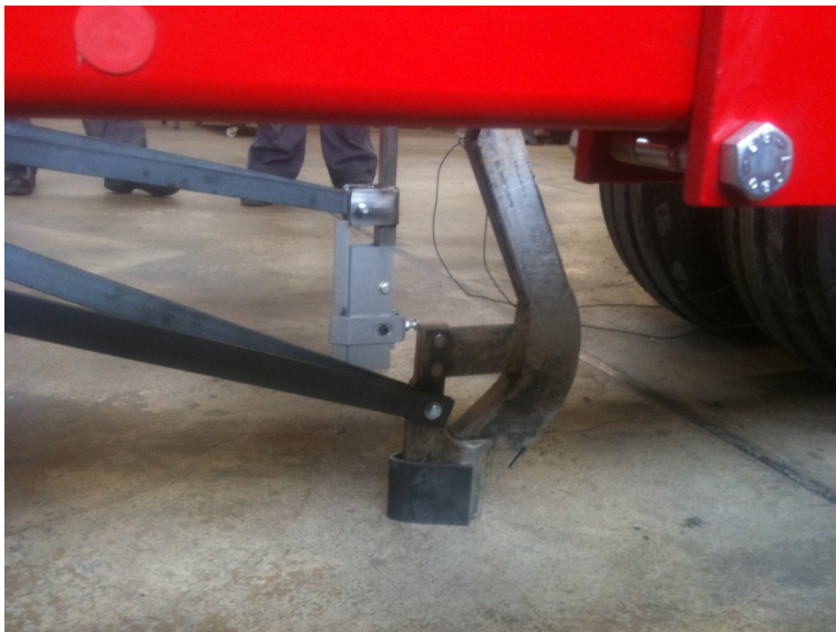
Fig 2. Mätbiller på plattformen. Närmast: bill med inmonterad NIR-sensor. Bakom: Bill för mätning av bearbetningsdjup.
