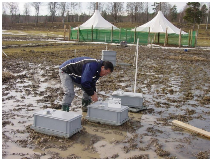
Figur 3. Mätning av lustgas och metan från marken.
