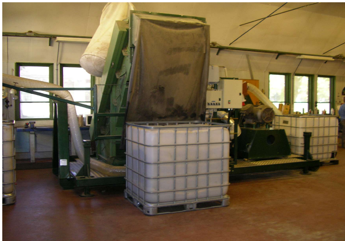
Figur 1. Prototypanläggningen. Till höger syns behållaren för inmatningsmaterial och hammarkvarnen, i mitten behållaren för fibermaterial och stegrensaren samt till vänster behållaren för vedämnesmaterial.
