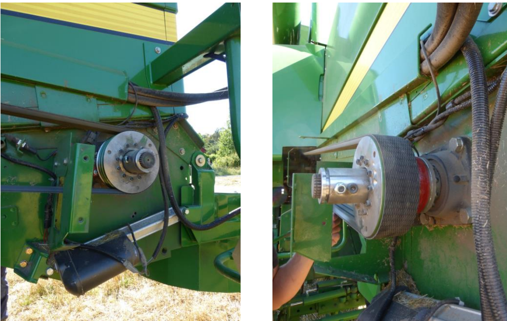
Figur 2. Inom projektet utvecklades utrustning för mätning av halmhackens vridmoment och varvtal. Utrustningen monterades på en skördetröska av modell John Deere T 660. 4 september 2013. Foto: Gunnar Lundin
