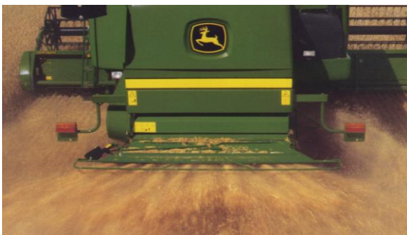
Figur 1. Halmhacken är monterad baktill på skördetröskan. Den utgörs av en rotor med pendlande knivar samt motknivar vilkas ingrepp är ställbart för att kunna variera hackselängden. I praktiken tillämpas oftast högsta möjliga sönderdelning d.v.s. att motknivarna är i maximalt ingrepp. Foto: Rekordverken
