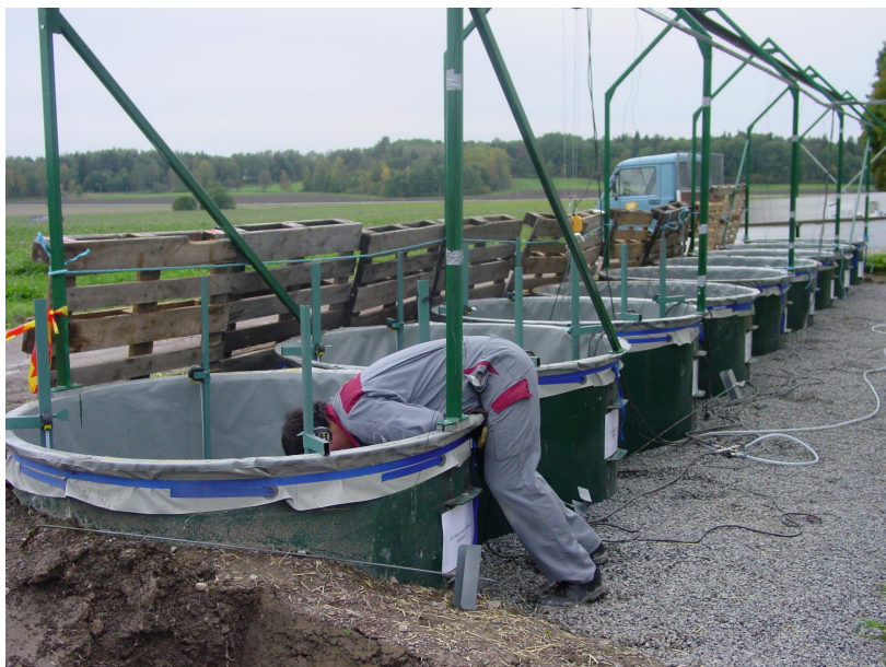
Bild 5. Pilotskalanläggning för mätning av växthusgaser från flytgödsellager placerad på JTI, Ultuna. Gasprovtagning pågår.
