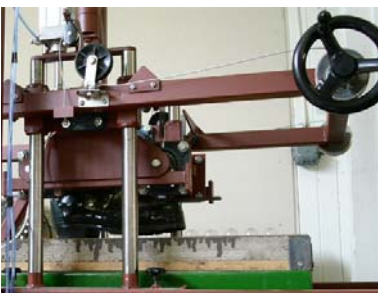
Bild 6. Vridreglage för inställning av skons avstånd till underlaget
