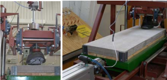
Bild 2. Vertikalt resp. horisontellt riktad hydraulisk kolv
