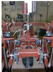
Bild 5. Lästen monteras i en vagg på vilken den vertikala kolven trycker
