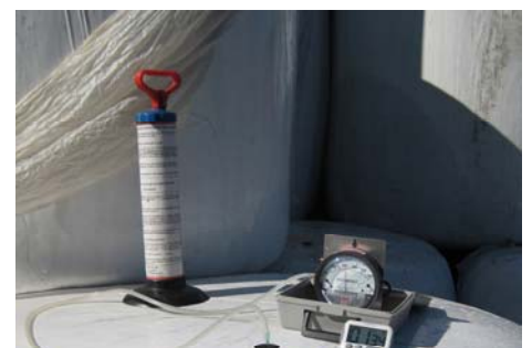
Figur 2 Klocka, pump samt tryckmätare kopplad till ventil vilka användes för täthetsbestämning
