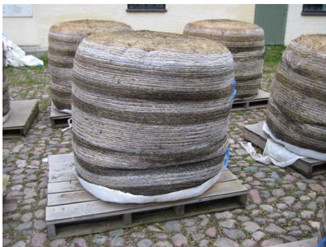
Figur 3. På grund av balarnas låga ts-halt var formstabiliteten dålig. Notera även att det finns kvarstående deformationer från hantering
