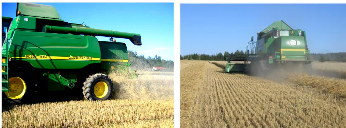
Figur 3. Fördelning av agnarna över skördetröskans arbetsbredd (vänstra bilden) respektive inblandning av denna fraktion i halmsträngen (högra bilden). Bärgning av Olivinvete med skördetröskan John Deere 9660i WTS. Viggeby, 19 augusti 2009. Foto: Gunnar Lundin
