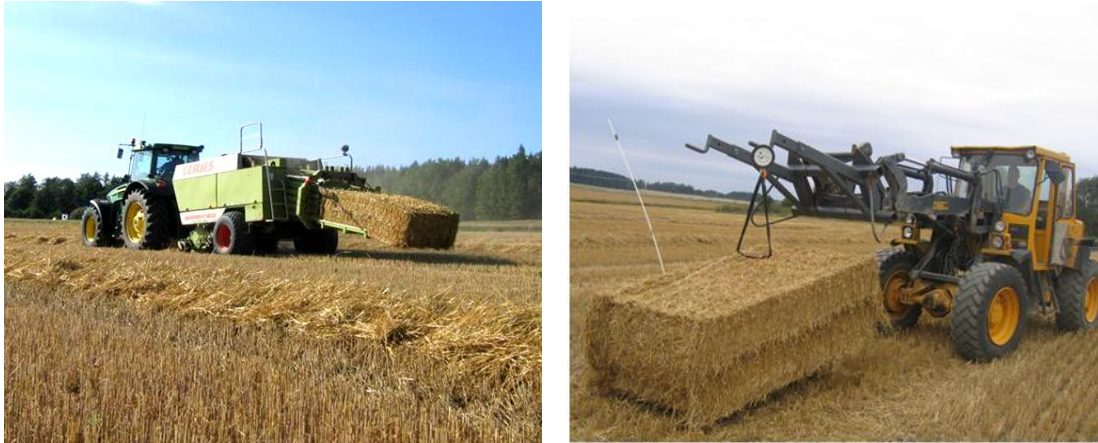
Figur 4. Halmen bärgades med en fyrkantbalpress, Claas Quadrant 1200. Balarna vägdes i fält med en fjädervåg. Viggeby 19 augusti 2009. Foto: Gunnar Lundin
