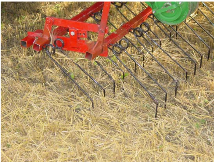
Figur 1. Försökströskan försågs med myllande utrustning i form av pinnar av samma typ som används på ogräsharvar.
