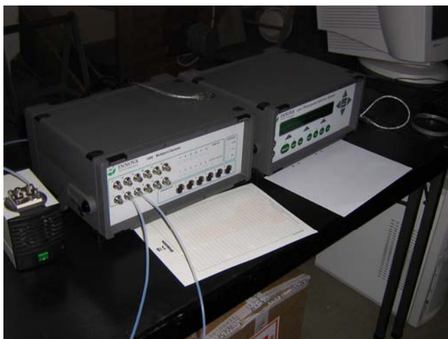
Figur 3. Foto-akustisk multigas-analysator, Innova 1412 och multiplexer, Innova 1309 (Lumasense Technologies A/S)
