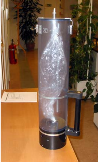
Figur 4. Vakuumprovtagare för luktprov (Ecoma).
