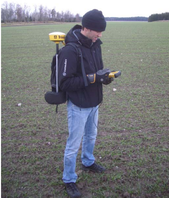
Figur 5. Avläsningar i försök kan göras med GNSS-mottagare kopplad till handdator (t v). Här visas en Recon handdator med Trimble AgGPS 332-mottagare i ryggsäck. Mjukvara för att registrera avläsningar och orientera sig i försök kan vara exempelvis Farm Site Mate från FarmWorks. Moderna, handhållna GNSS-mottagare med Windows Mobile som operativsystem gör att alla funktioner kan paketeras i en enda handhållen enhet. Trimble GeoXH (t h) kan ge decimeter-noggrann positionering men kräver då att en extern antenn används
