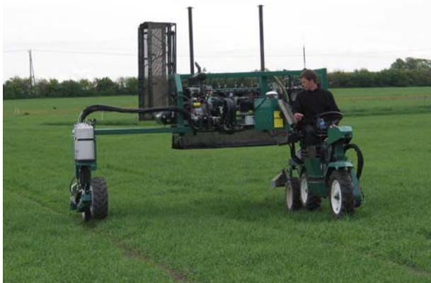
Figur 3. Träning med GNSS-styrd spruta
