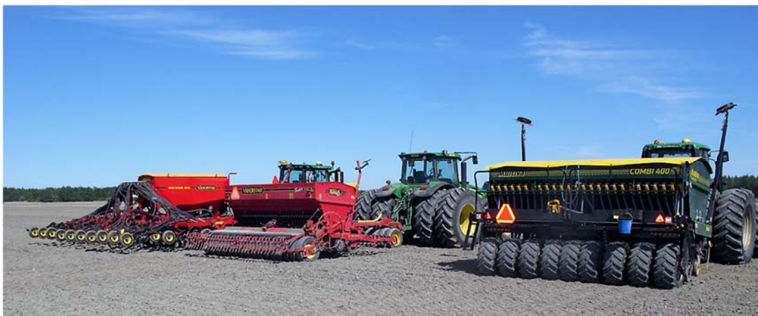
Figur 2. Sådd av direktsåddförsök vid Enköping 2018. Från vänster: Direktsådd med Väderstad Seed Hawk, sådd med Väderstad Rapid efter kultivering och harvning samt direktsådd med Multiva Combi. Foto: Ola Lundin.
