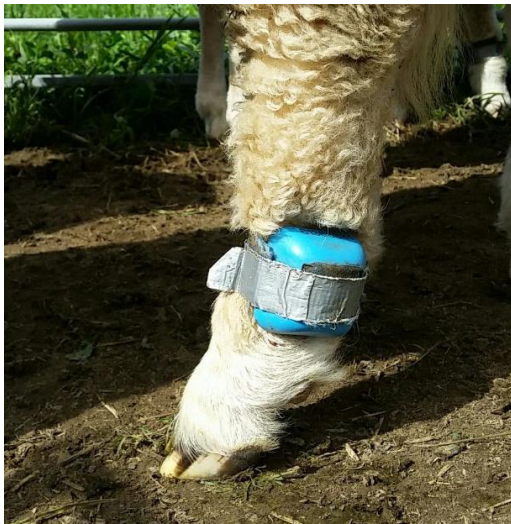
Bild 1. IceQube, aktivitetsmätare som registrerar tid liggande, tid stående och antal steg.
